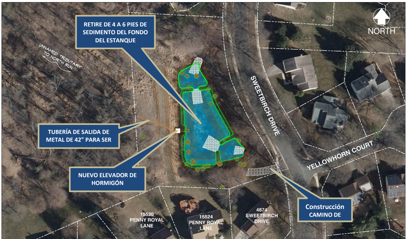
Mejoras en el estanque de aguas pluviales de Norbeck Manor
