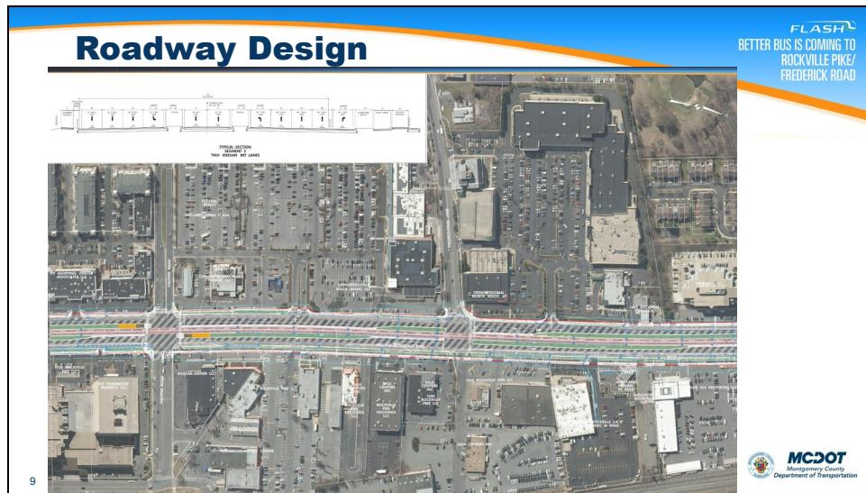
马里兰州 355 号公路上的 Flash BRT 现行道路设计方案已在[网上公布](#)，供您查阅。设计图不仅显示 Flash BRT 车道位置，还显示将进行道路拓宽的位置、车站位置，以及走廊沿线不同位置将有哪些行人和自行车设施。请借此机会审读这些设计，并提供您的反馈。郡政府将利用公众和其他利益相关者提供的意见，来为日后设计更新决定提供信息。对此设计之福利和影响的联邦审查也将完成，以为在下一个项目阶段最终确定这些道路的设计决定提供信息。
